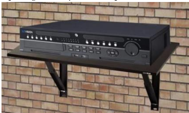
Hình 2.31 Minh họa cách lắp giá đỡ treo đầu ghi camera lên tường
