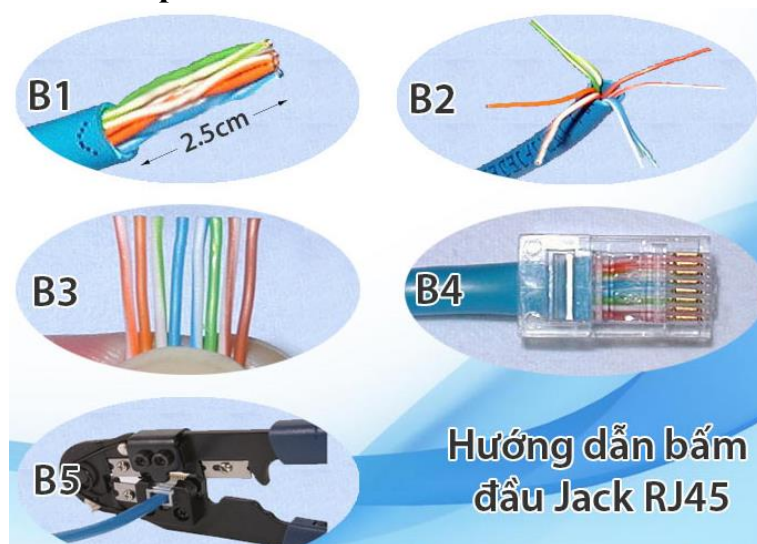
Hình 2.36 Cách bấm đầu cáp RJ45 cho camera
