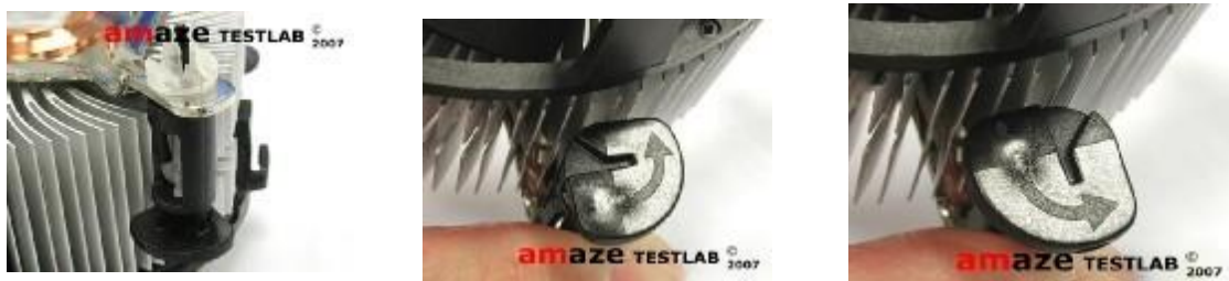
Hình 1.21: Kiểm tra các chốt khóa quạt CPU
