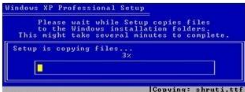
Hình 3.18: Setup sao chép các file cần thiết của WinXP từ CD vào ổ cứng
