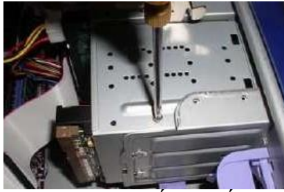
Hình 1.41: Bắt vít cố định ổ đĩa Cắm dây cung cấp nguồn cho HDD.
