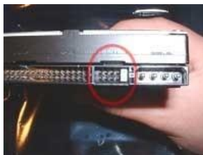
Hình 1.39: Cách lắp cáp dữ liệu và cáp nguồn cho ổ đĩa cứng
