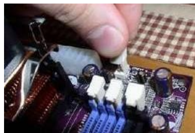
Hình 1.26: Lắp dây nguồn quạt CPU
