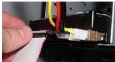
Hình 1.43: Lắp cáp dữ liệu cho ổ đĩa Cắm đầu dây còn lại vào khe cắm trên Mainboard. Lưu ý đầu cắm và khe cắm đều có khớp để tránh cắm sai và sợi dây màu đỏ tương ứng với chân số Các HDD đời mới (SATA) sẽ dùng cắm theo chuẩn khác, đối với dây dữ liệu nếu Mainboard không hỗ trợ loại chuẩn cắm này thì có thể dùng Card SATA để chuyển đổi.
