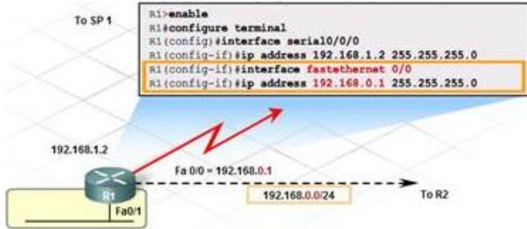
Hình 4.61 Cấu hình mô hình RIP
