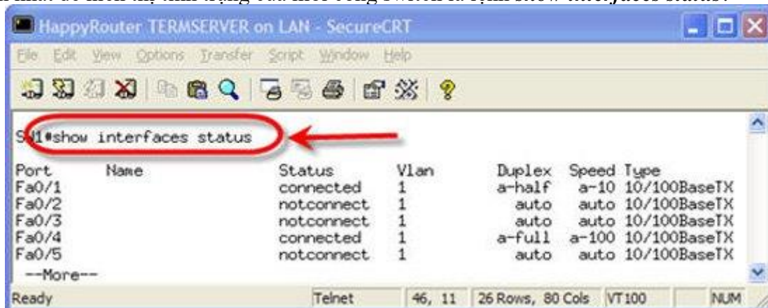
Hình 5.4 Cấu hình Switch
