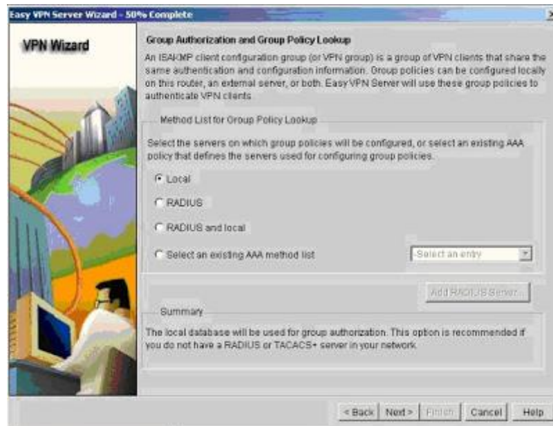
Hình 4.49 Giao diện cấu hình Cấu hình chứng thực trên Easy VPN Server
