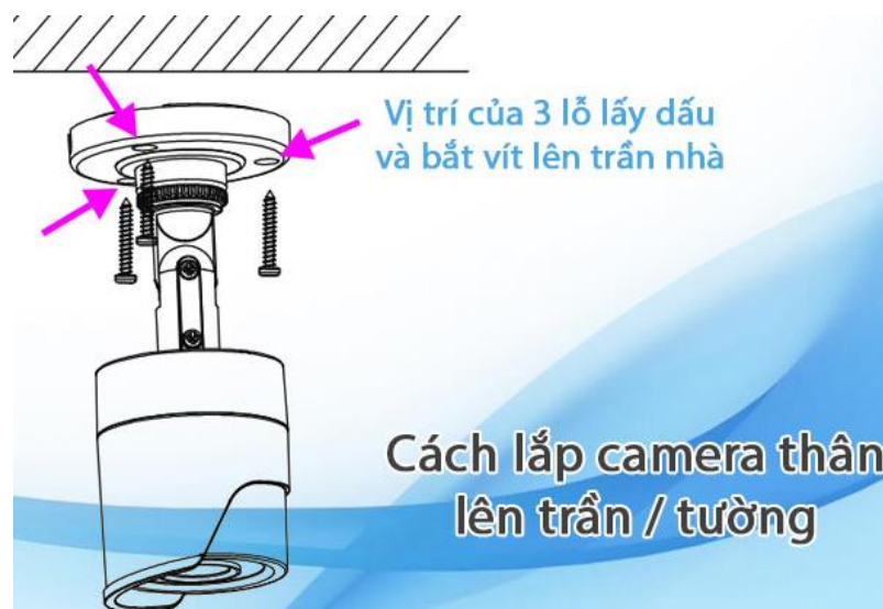
Hình 2.27 Lắp camera thân cố định lên trần nhà / tường nhà
