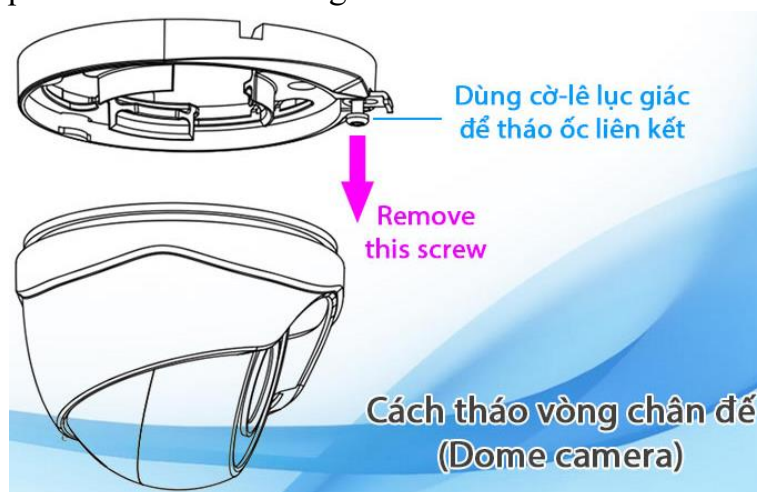
Hình 2.22 Cách tháo vòng chân đế camera dome để gắn lên trần nhà
