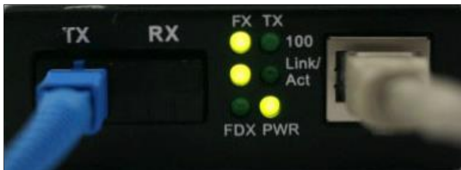
Hình 4.4 Bộ chuyển đổi quang điện 10/100Mbps mất tín hiệu LAN
