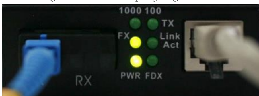
Hình 4.7 Bộ chuyển đổi quang điện 1GB mất kết nối LAN
