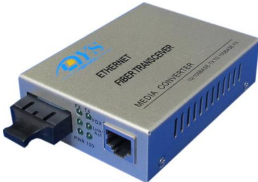
Hình 4.9 Kiểm tra đèn trên bộ Media Converter
