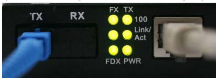
Hình 4.5 Bộ chuyển đổi quang điện 10/100Mbps mất tín hiệu LAN
