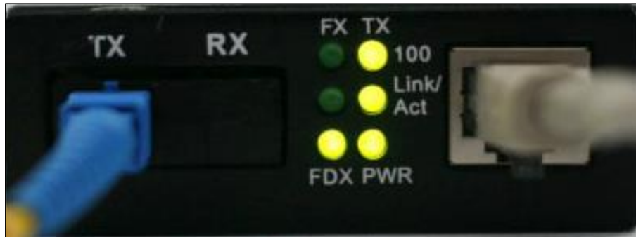
Hình 4.3 Converter quang - Bộ chuyển đổi quang điện 10/100 Mbps mất tín hiệu quang
