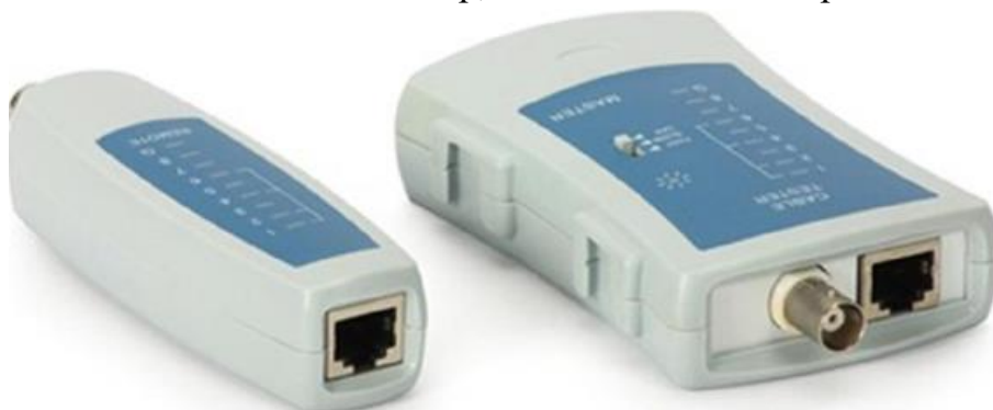
Hình 1.3 Thiết bị kiểm tra dây cáp mạng RJ45
