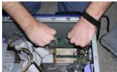
Hình 1.28: Lắp Card vào thùng máy
