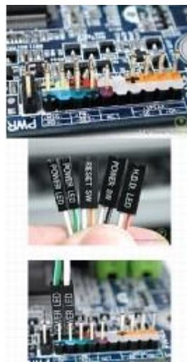
Hình 1.51: Ký hiệu các đầu dây công tắc của Case
