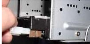
Hình 41.2: Lắp nguồn cho ổ đĩa Cắm đầu dây cáp dữ liệu (ATA có 80 đầu dây) vào HDD.
