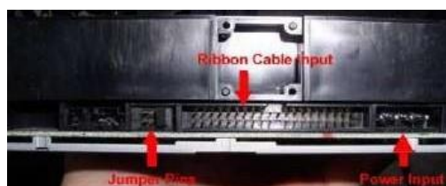
Hình 1.47: Vị trí lắp cáp dữ liệu và cáp nguồn cho ổ đĩa CD
