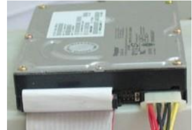
Hình 1.39: Cách lắp cáp dữ liệu và cáp nguồn cho ổ đĩa cứng
