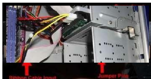
Hình 1.40: Cách đặt ổ đĩa cứng vào thùng máy
