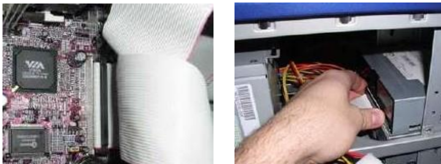
Hình 41.8: Lắp cáp dữ liệu và nguồn vào main
