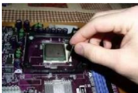
Hình 1.23: Gạt thanh giữ CPU
