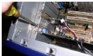
Hình 1.29: Lắp vít cố định Card
