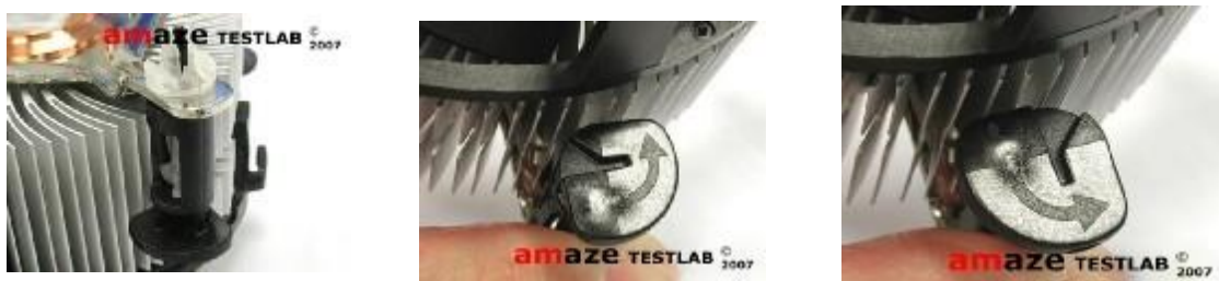
Hình 1.21: Kiểm tra các chốt khóa quạt CPU
