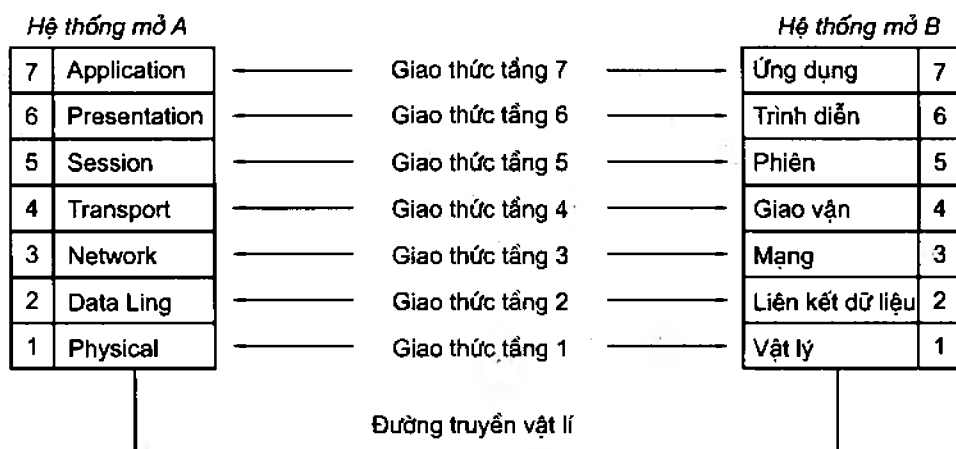
Hình 2.2. Mô hình OSI 7 tầng
