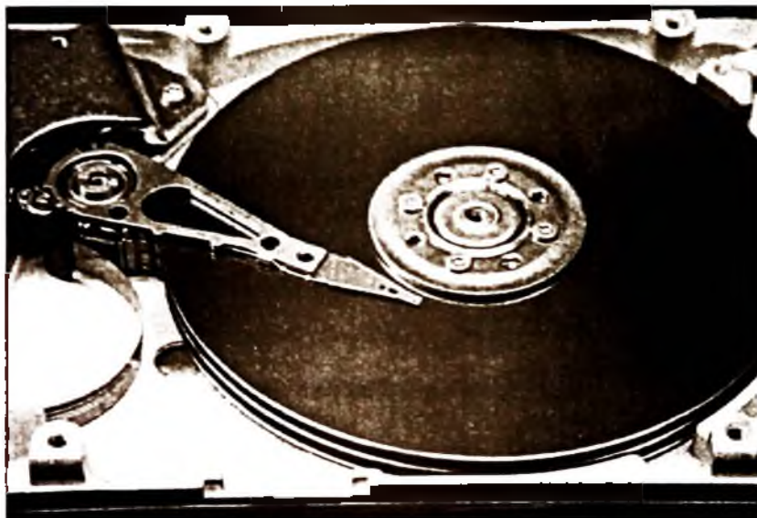
Hình 67. Trục quay của ổ đĩa cứng
