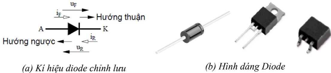
Hình 2.1 - Kí hiệu và hình dáng Diode
