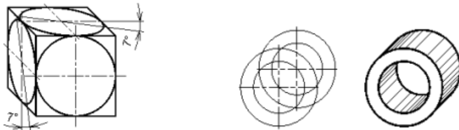
Hình 5.7: Hình chiếu trục đo xiên góc cân của các đường tròn
