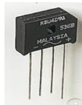
Hình 1.1.15: Diode cầu trong mạch chỉnh lưu điện xoay chiều.
