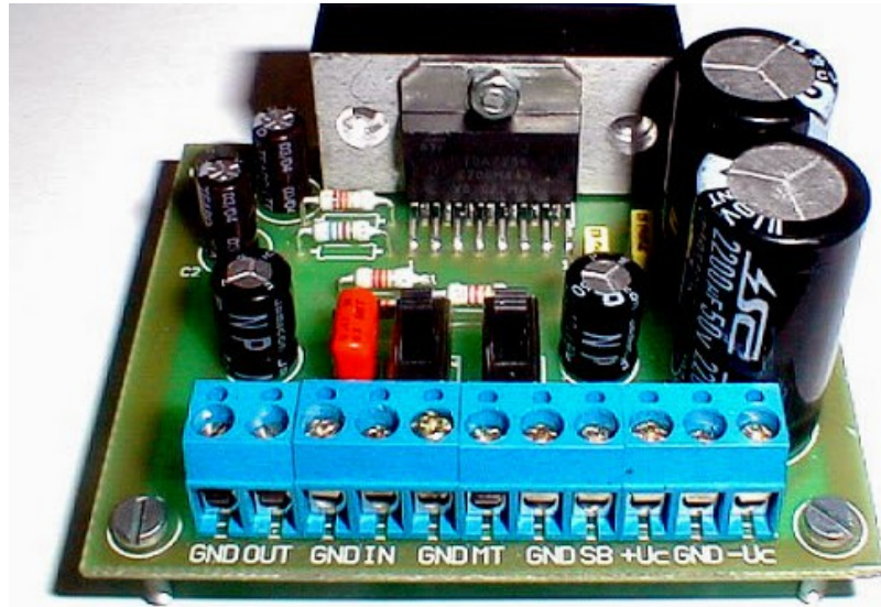
Hình 3.45: Mạch khuếch đại dùng IC sử dụng IC TDA7294 Sơ đồ nguyên lý:
