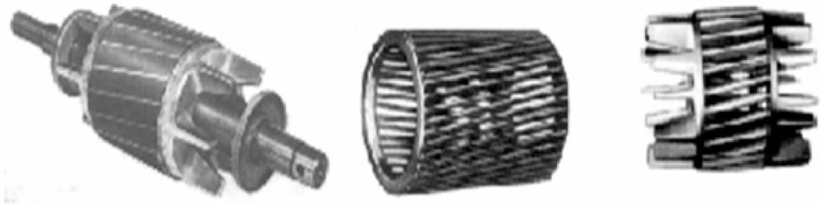
Hình 18-03-2 Rotor lồng sóc động cơ điện không đồng bộ
