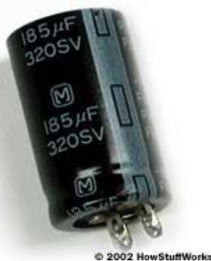
Hình 2.21. Tụ hoá ghi điện dung là 185 \mu F / 320 V
