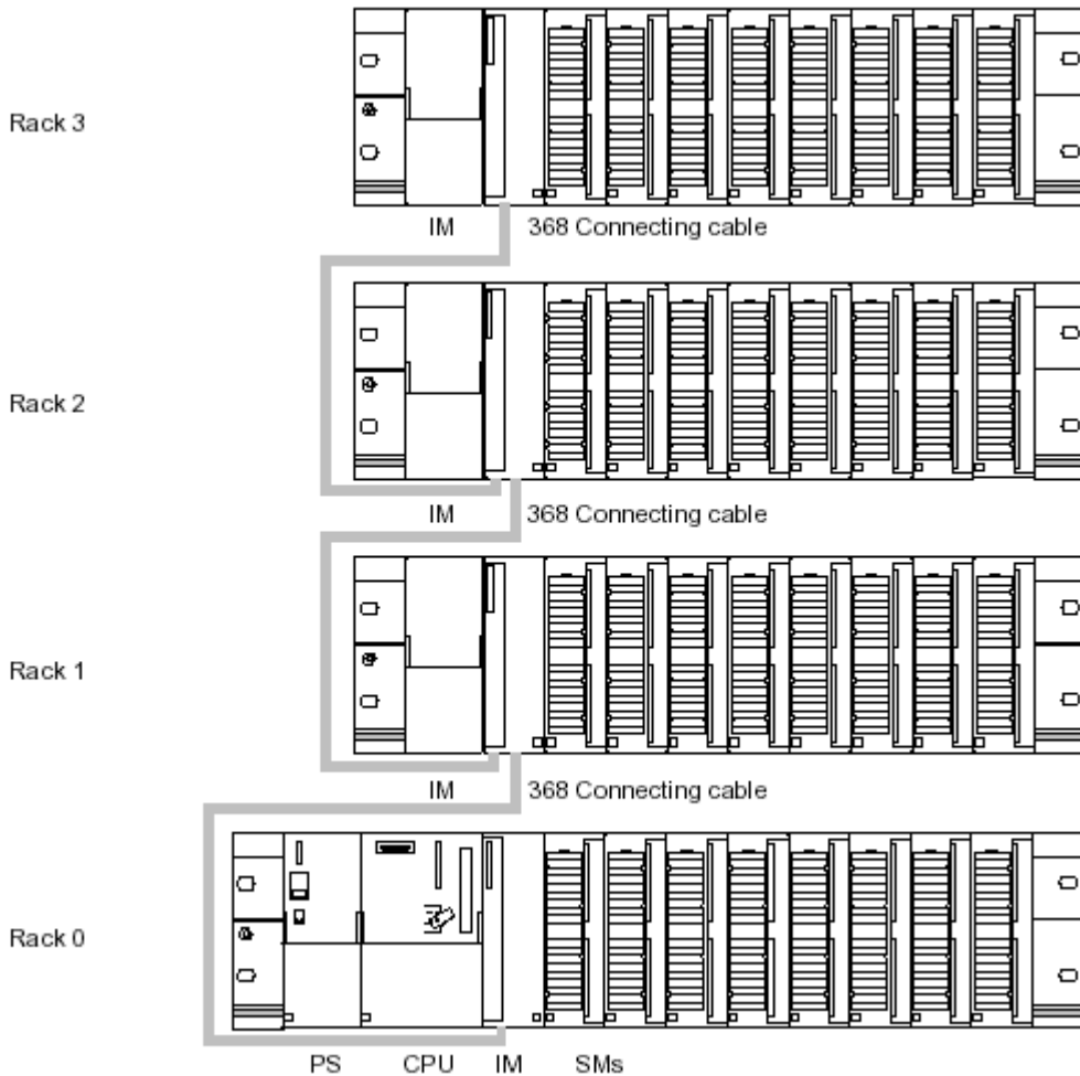
Hình 2.6 Cấu hình tổng quát của một PLC S7-300 với 4 thanh rack nối với nhau nhờ module IM và cáp nối 368
