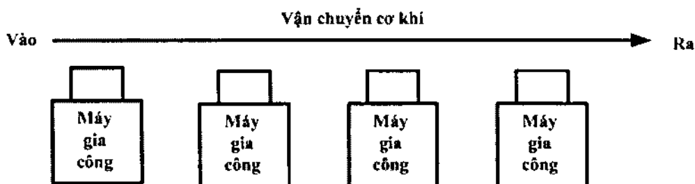
Hình 7.11 Nhóm máy với hệ thống vận chuyển bán tự động, mặt bằng thẳng.
