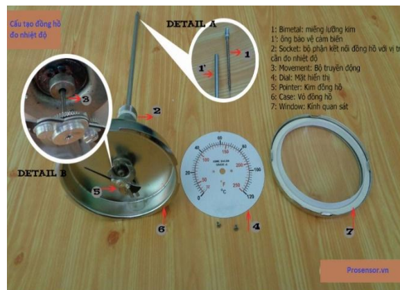
Hình 1.39. Cấu tạo của đồng hồ đo nhiệt độ dạng cơ
