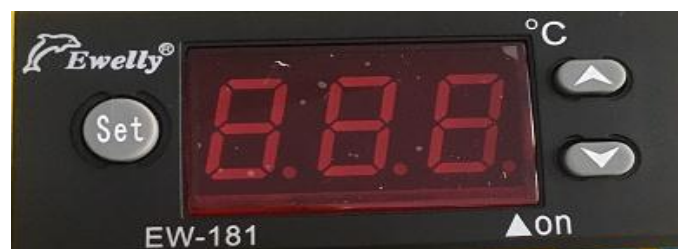
Hình 1.42. Hình dáng ngoài của đồng hồ đo nhiệt độ EW181
