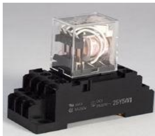
Hình 1.21. Hình dạng ngoài của role trung gian (role kiến)
