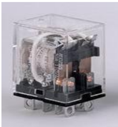
Hình 1.21. Hình dạng ngoài của role trung gian (role kiến)
