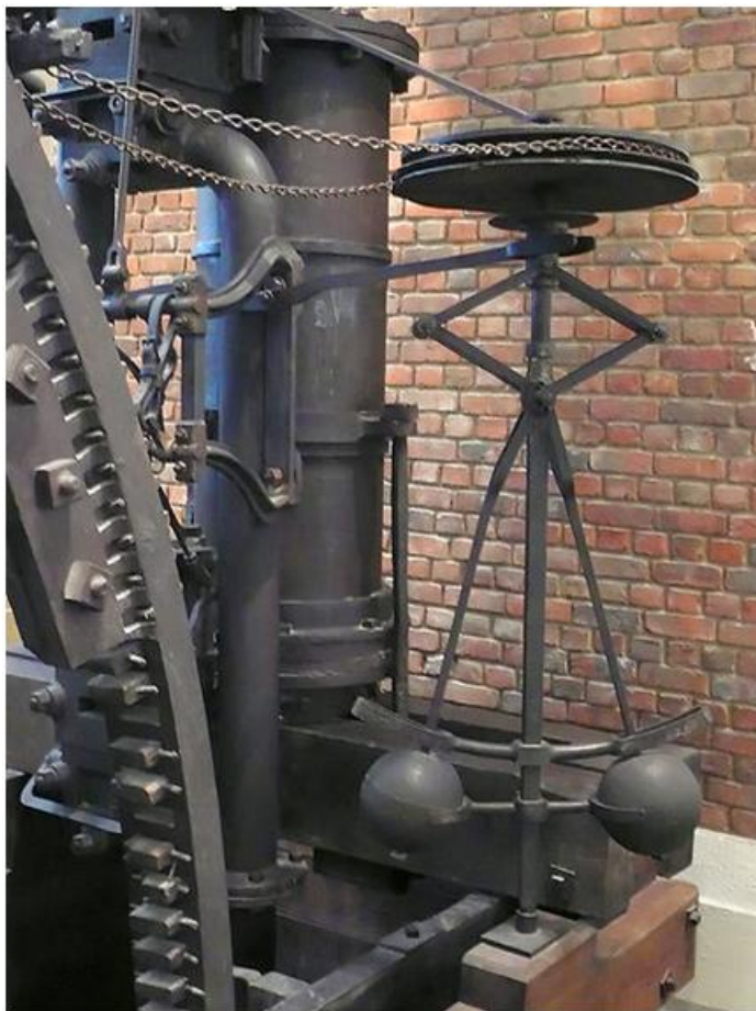
Hình 1-1: Bộ điều tốc ly tâm kiểu Watt (1788) lắp đặt trên một máy hơi nước Boulton and Watt tại Bảo tàng khoa học, London.
