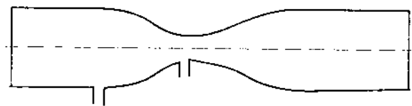
Hình 9.7. Sơ đồ cấu tạo của ống thu hẹp chuẩn
