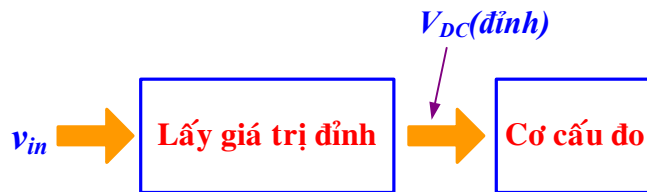
Hình 3.22. Đo điện áp AC sử dụng phương pháp trị giá trị đỉnh
