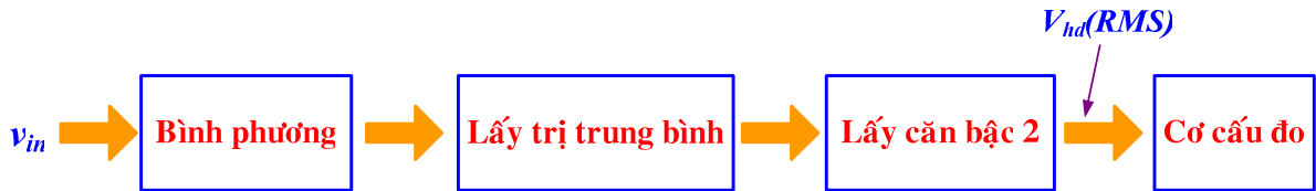
Hình 3.21. Đo điện áp AC sử dụng phương pháp trị hiệu dụng thực
