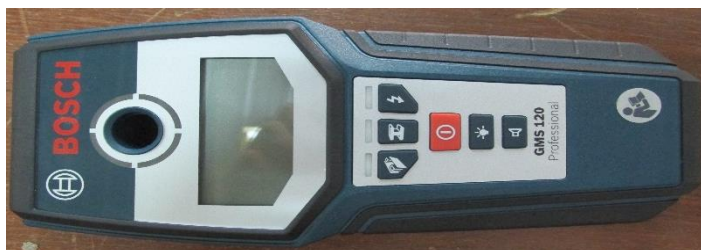
Hình 2.25: Máy đo dây điện trong tường
