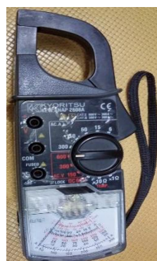
Hình 2.28: Ampe kìm a) Ampe kìm số b) Ampe kìm kim
