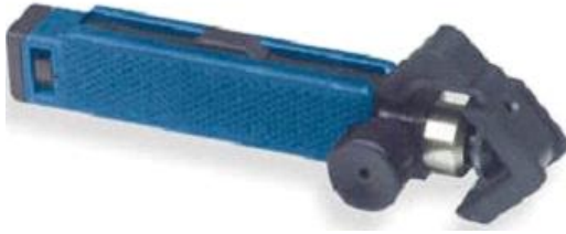
Hình 2.14: Dao gọt vỏ dây điện
