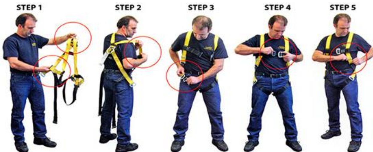
Hình 2.2: Cách sử dụng dây đai an toàn
