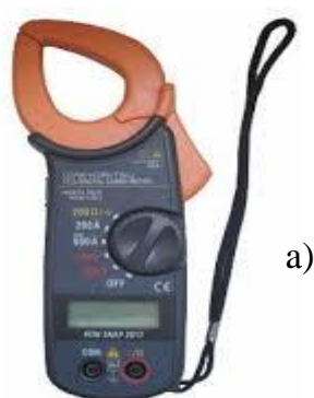
Hình 2.28: Ampe kìm a) Ampe kìm số b) Ampe kìm kim
