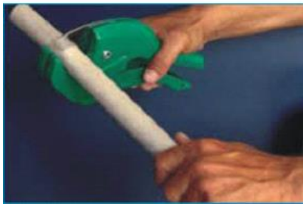
Hình 2.15: Kéo cắt ống nhựa cứng
