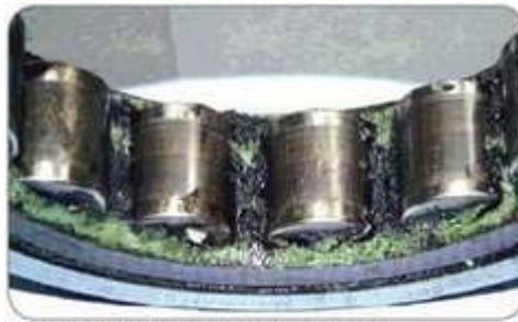
Chất bồi trơn bị thoái hóa do phóng xạ qua vòng bị
