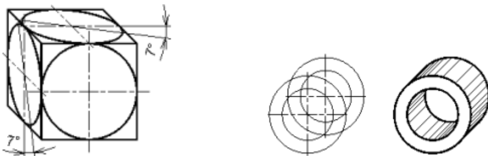
Hình 5.6: Hình chiếu trục đo xiên góc cân của các đường tròn
