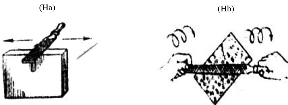
Hình 3.10: Đánh bóng bằng giũa
