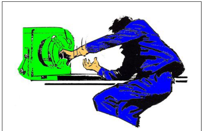
Không được dùng tay chạm vào mâm cặp khi mâm đang quay
