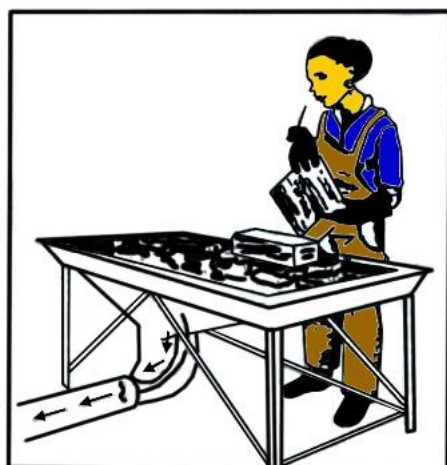
HÚT BỤI RA KHỎI KHU VỰC HÍT THỞ CỦA NGƯỜI LAO ĐỘNG
