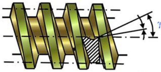
Mài vát dao , khi tiện ren thang bước lớn
