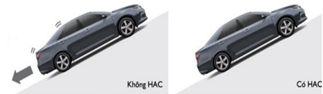
Hình 3-36: Hệ thống hỗ trợ khởi hành ngang dốc
