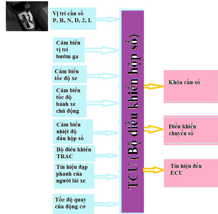
Hình 3-5b: Sơ đồ điều khiển điện tử hộp số thủy cơ
