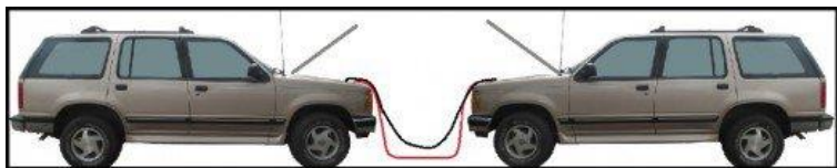
Hình 6.18: Kết nối ắc quy để khởi động động cơ
