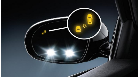
Hình:5-3 hệ thống cảnh báo điểm mù có xe từ phía sau bên trái tiếp cận
