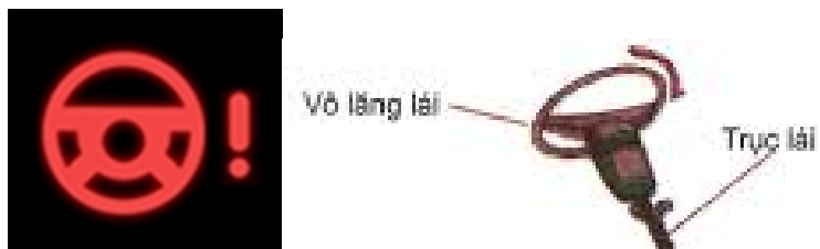
Hình 6.15: Dấu hiệu hệ thống lái gặp sự cố
