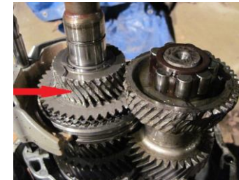
Hình 6.13: Bánh răng của hộp số bị xứt
