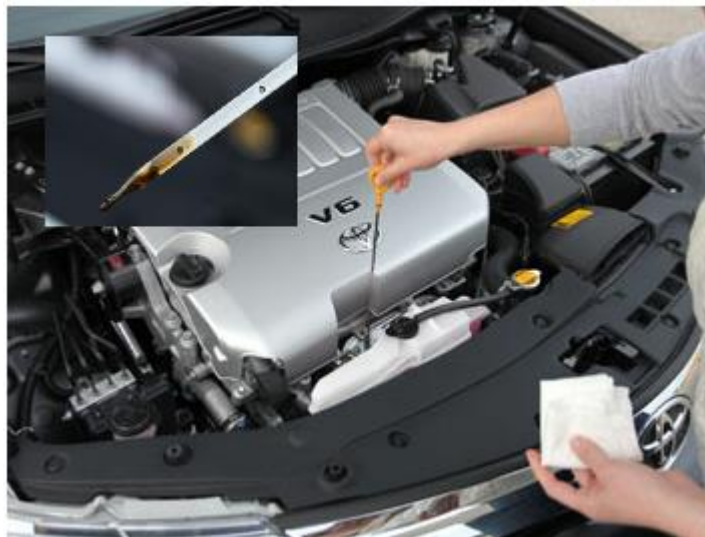
Hình 8.2: Kiểm tra mức dầu động cơ
