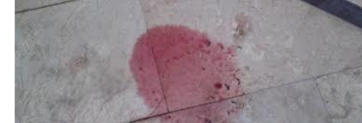
Hình 6.6: dầu rò rỉ từ hộp số tự động
