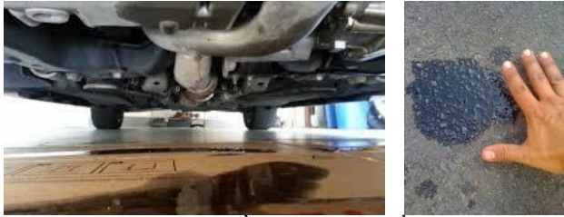
Hình 6.3: dầu rò rỉ dưới gầm xe
