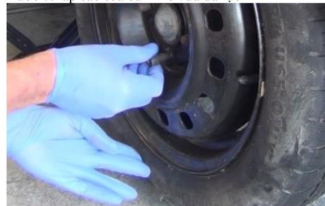
Hình 7.11: lắp các e cu bánh xe
