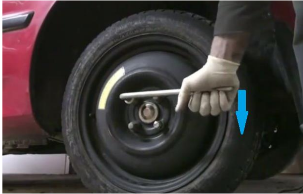
Hình 7.13: siết chặt các ốc lắp bánh xe
