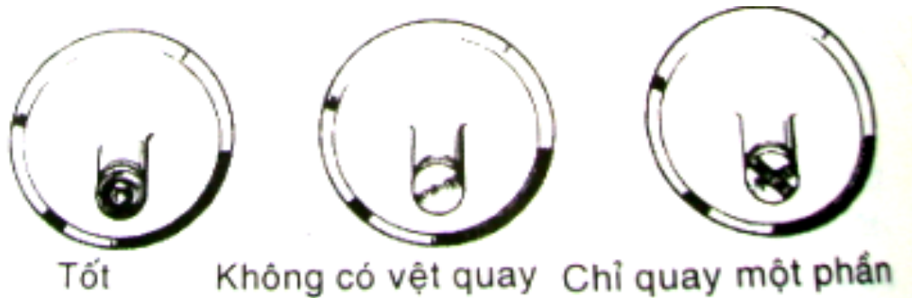
Hình 5-14 Vết mòn đỉnh thân xu páp với các bộ quay van
