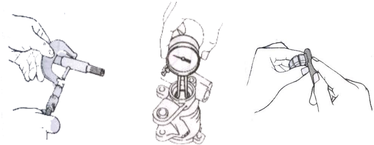
Hình 5 Kiểm tra các chi tiết của bơm trợ lực a. Kiểm tra trực bơm; b. Kiểm tra xy lanh bơm; c. Kiểm tra rô to bơm
