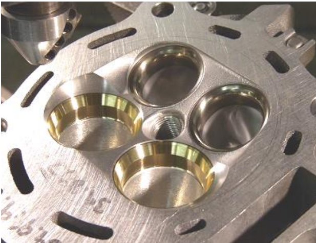
Hình 3.4. Cấu tạo đế xupáp
