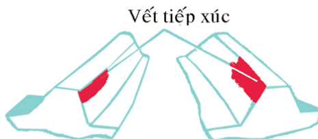
Hình 5.48: Vết tiếp xúc khi vành răng xa đường tâm cùi thom
