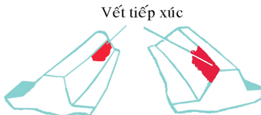
Hình 5.51: Vết tiếp xúc khi bán kính chủ động gần đường tâm vành răng (vị trí vành răng đúng).
