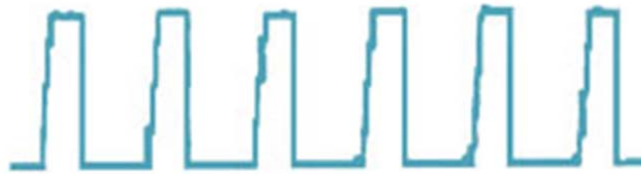
Hình 5.61: Dạng xung điện áp ở đầu âm cuộn dây sơ cấp.
