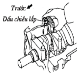
Lắp nắp đầu to
