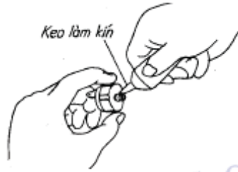
Bôi keo vào ren cam biến
