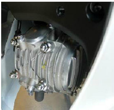
Hình 2.3 Làm mát động cơ bằng gió
