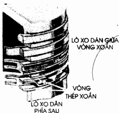
Hình 18. Piston và vòng găng bốn mảnh có lò xo dãn ở giữa.
