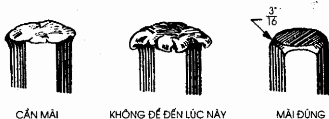
Hình 14. Luôn đẽo gọt chuỗi đục hoặc đột khi bắt đầu có dạng hình nấm. Phoi bắn ra khi đục hoặc đột có thể đâm sâu vào cơ thể.
