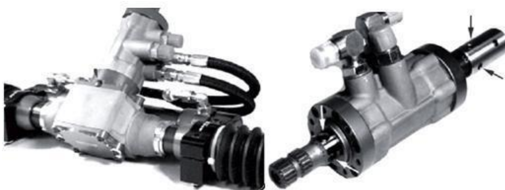
Hình 5.11. Hình dáng bên ngoài của hai bộ trợ lực dùng van xoay lắp đặt trên cơ cấu lái loại thanh răng – bánh răng
