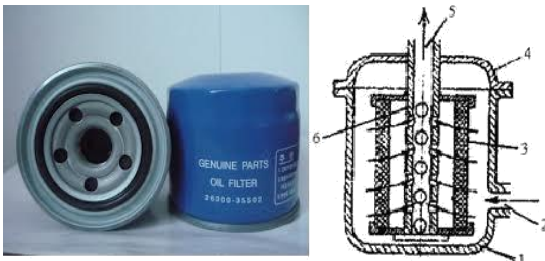
Hình 1.16. Bầu lọc thấm lõi lọc bằng giấy 1. Thân bầu lọc, 2. đường dầu vào, 3. lõi lọc, 4. nắp bầu lọc, 5. đường dầu ra, 6. trục bầu lọc
