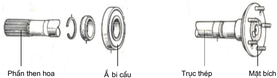
Hình 5 - 4 : Cấu tạo bán trục giảm tải 1/2
