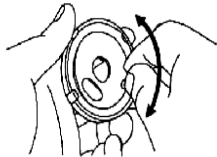
Hình 6.12 Kiểm tra mâm chia điện.
