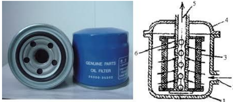
Hình 1.16. Bể lọc thấm lõi lọc bằng giấy 1. Thân bể lọc, 2. đường dầu vào, 3. lõi lọc, 4. nắp bể lọc, 5. đường dầu ra, 6. trục bể lọc
