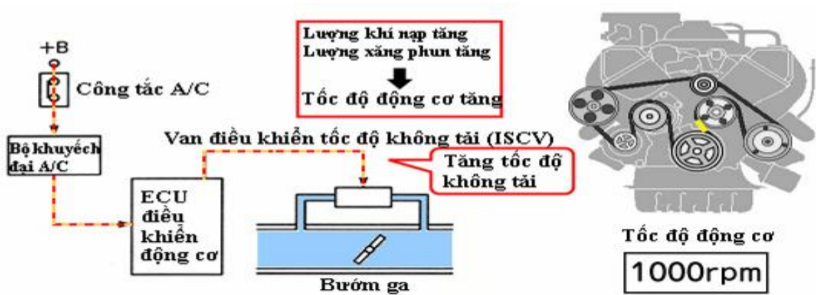
Hình 2.18. Sơ đồ điều khiển bù ga bằng điện
