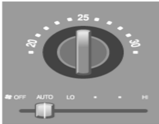
Hình 1.6. Hệ thống lạnh điều chỉnh nhiệt độ tự động
