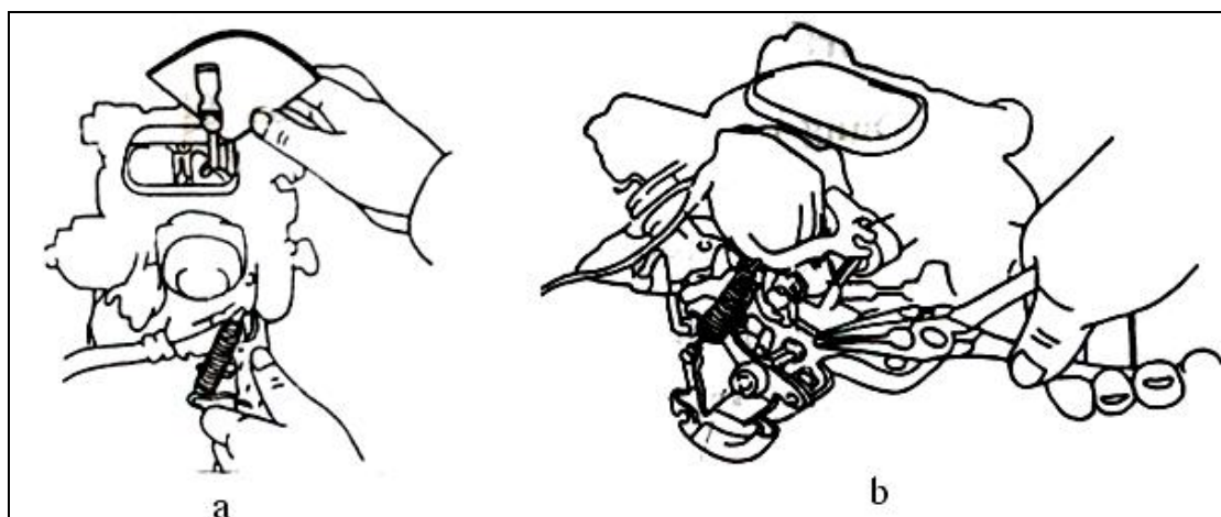
Hình 3.25. Điều chỉnh cơ cấu liên động mở bướm gió
