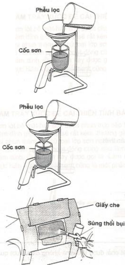
Hình 19: Đổ sơn vào súng và phun sơn
