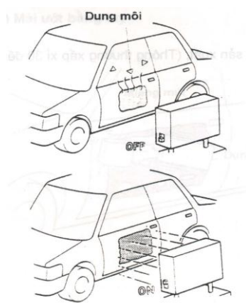
Hình 77: Chú ý khi sơn lót bề mặt
