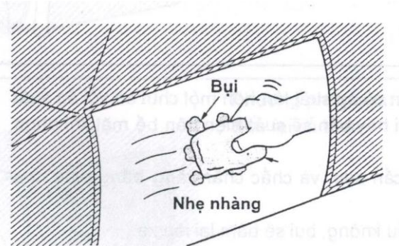
Hình 66: Làm sạch bằng miếng giẻ dính
