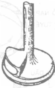
Hình 9. Xu páp hút có đúc gờ nhằm tạo xoáy lốc trên động cơ Diesel Kromhout.
