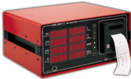
Hình 7: Thiết bị phân tích khí xả HERMANN
