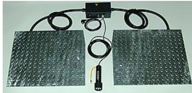
Hình 12 : Thiết bị đo độ trượt ngang
