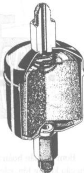
Hình 4.9. Phin sấy lọc cho máy Frêon cố trung bình
