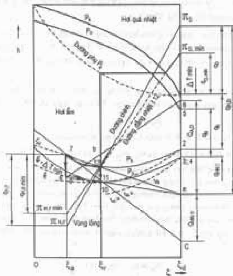
Hình 11.14 : Đồ thị t - \xi để tính toán các quá trình trong máy lạnh cấp thụ \text{NH}_3/\text{N}_2\text{O} .
