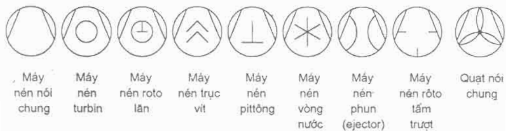
Hình 5-3. Một số ký hiệu tiêu chuẩn ISO của van, thiết bị trao đổi nhiệt, bơm, máy nén, mô tơ (động cơ)
