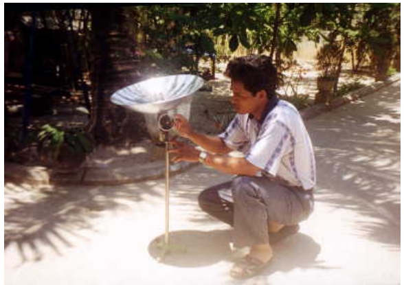
Hình 4.98. Động cơ Stirling năng lượng mặt trời công suất 5W tốc độ 1000 v/ph.
