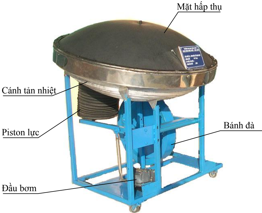
Hình 4.103. Bơm nước dùng năng lượng mặt trời công suất 5\text{m}^3/\text{ngày}
