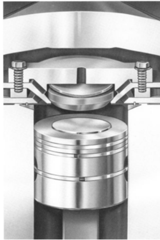
Hình 2-15: Cơ cấu van đĩa làm giảm thể tích chết
