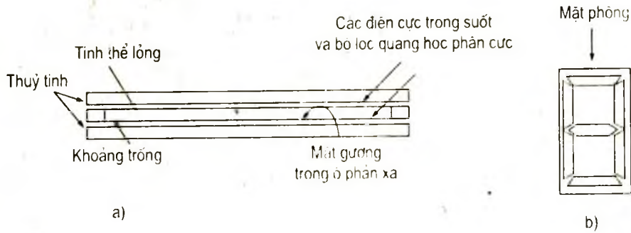
Hình 2 - 40 . Cấu tạo ô tinh thể lỏng và bộ hiển số bảy thanh a) Cấu tạo b) Bộ hiển số bảy thanh
